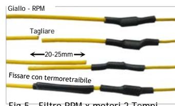
Fig.5 - Filtro RPM x motori 2 Tempi
