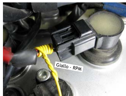
Fig.3 - Ingresso bobina bassa tensione 7-10 giri
