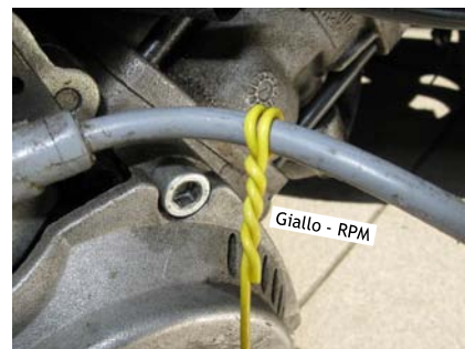
Fig.2 - Cavo candela alta tensione 1-2 giri
