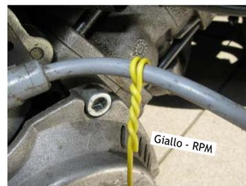
Fig.2 - Cavo candela alta tensione 1-2 giri
