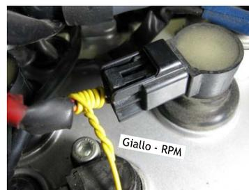
Fig.3 - Bobina bassa tensione 7-10 giri
