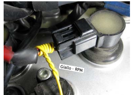
Fig.3 - Ingresso bobina bassa tensione 7-10 giri
