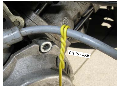
Fig.2 - Cavo candela alta tensione 1-2 giri
